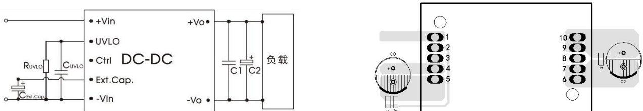
图 7 掉电保持时间推荐电路和 PCB 布局
