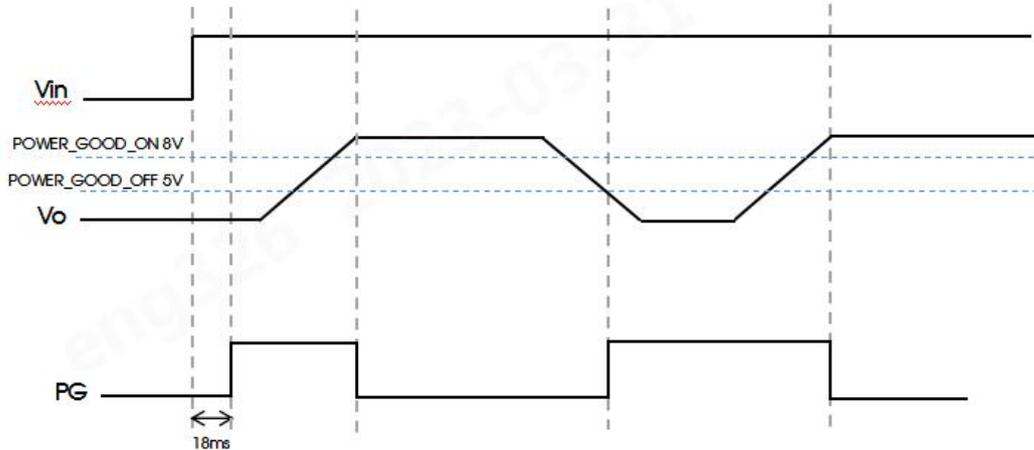
电源良好引脚 (PG) 指示产品何时准备好向负载提供输出电压。在上升和故障状态下, PG 保持为高电平。默认情况下, 上升时间结束, 如果输出电压上升到 PG 阈值 (典型值 8V) 以上时, PG 被置为低电压, 输出电压下降到 PG 阈值 (典型值 5V) 以下则 PG 复位。可以使用 PMBus 命令 POWER\_GOOD\_ON (0x5E) 和 POWER\_GOOD\_OFF (0x5F) 来更改 PG 的阈值。PG 引脚默认为推挽输出, 低电平有效。设备默认 PG 引脚为 Power Good 功能, 当 Interleave (0x37) 的 Number 不为 0 时, PG 引脚复用为 Interleave 功能。
