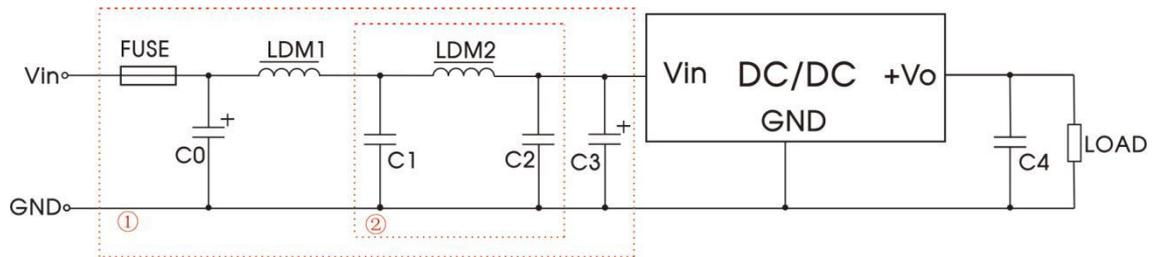
图4 EMC 推荐电路
