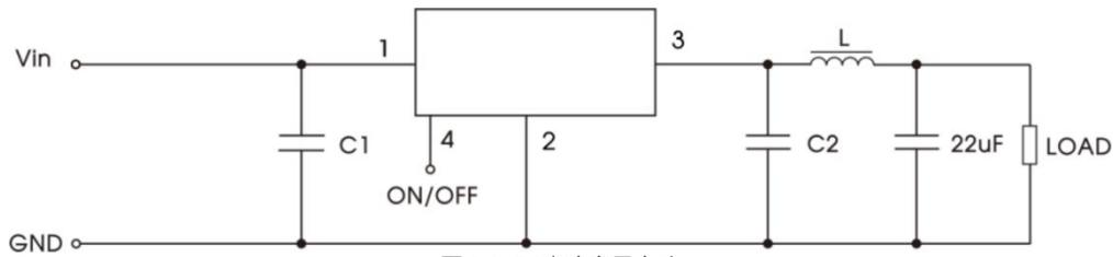
图3 “LC”滤波应用电路
