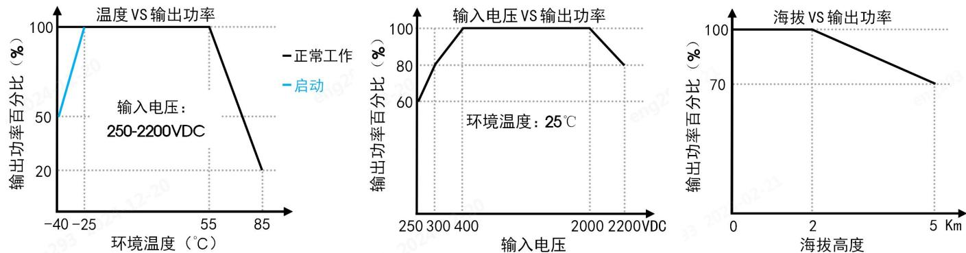
注: 1.对于输入电压为 250-400VDC/2000-2200VDC, 需在温度降额的基础上进行电压降额;
