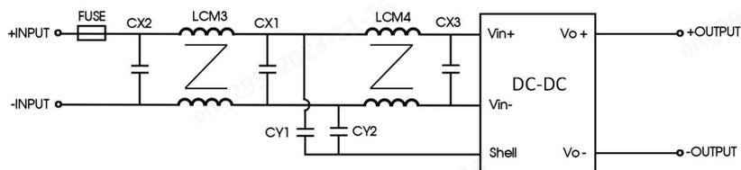
图 3: CLASS II 推荐电路
