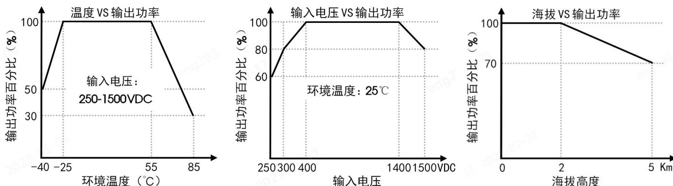
注: 1.对于输入电压为 250-400VDC/1400-1500VDC, 需在温度降额的基础上进行电压降额;
