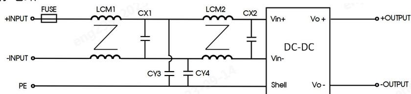
图 2: CLASS I 推荐电路
