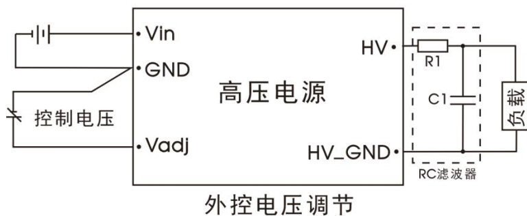
图 3 输出电压外部调节方式
