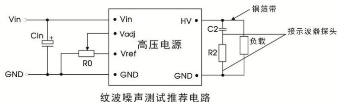
图 4 纹波噪声测试推荐电路
