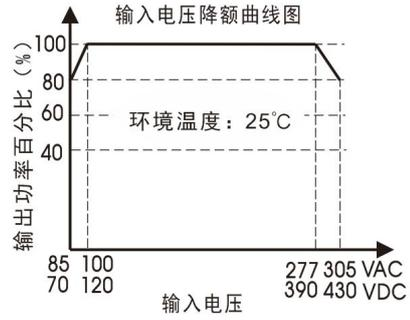
注: ①对于输入电压为 85-100VAC/277-305VAC/70-120VDC/390-430VDC, 需在温度降额的基础上进行电压降额;
