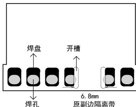
注：4、5脚隔离带侧开槽（非金属孔），切除4、5脚隔离带侧焊盘，具体尺寸请参考外观尺寸图中的推荐焊孔设计。
