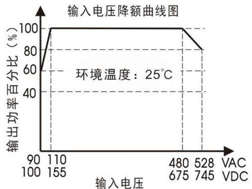
注: ①对于输入电压为 90-110VAC/480-528VAC/100-155VDC/675-745VDC, 需在温度降额的基础上进行电压降额;
