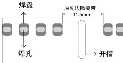
注：4、5脚隔离带侧开槽（非金属孔）；具体尺寸请参考外观尺寸图中的推荐焊孔设计。
