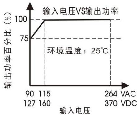
注：对于输入电压为 90 - 115VAC/127 - 160VDC 需在温度降额的基础上进行输入电压降额。
