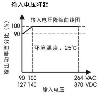
注: 1.对于输入电压为 90 - 100VAC/127 - 140VDC 需在温度降额的基础上进行输入电压降额;
