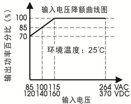
注: 对于输入电压 85 - 115VAC/120 - 160VDC 需在温度降额的基础上进行输入电压降额。
