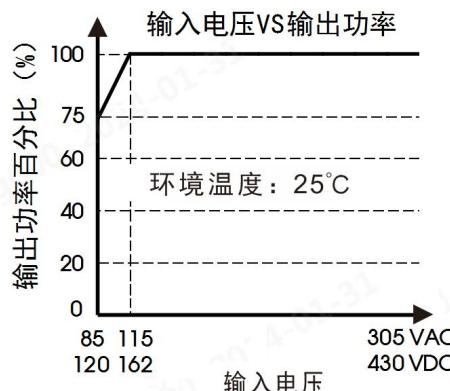
注：1. 对于输入电压为 85 - 115VAC/120 - 162VDC 需在温度降额的基础上进行输入电压降额；
