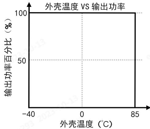
注: 1.对于输入电压为 85-180VAC/180-320VDC 需在温度降额的基础上进行输入电压降额;
