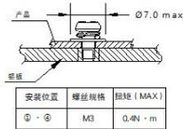
注: 1. 为了满足“降额曲线”, 产品必须安装在铝板上进行测试, 铝板建议尺寸如图所示, 同时为了保证导热性能, 需在产品底部涂抹导热硅脂。
