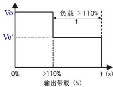
当主路输出电流超过 110%(最小值)的额定输出电流后, 恒流输出 3S (典型值) 后输出关闭, 重启后恢复, 辅路输出不受影响。
