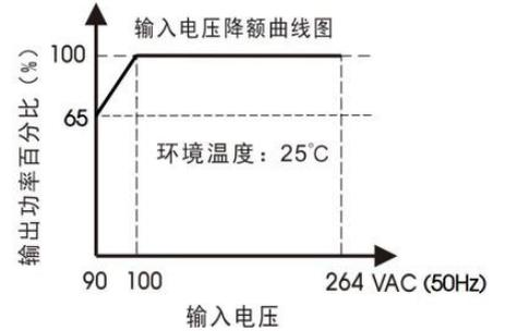
注: ①对于输入电压为 90 - 100VAC, 适用于上述温度降额曲线, 但需在温度降额的基础上进行电压降额;
