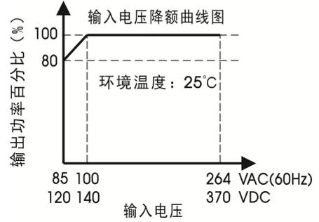
注: ①对于输入电压为 85-100VAC/120-140VDC, 需在温度降额的基础上进行电压降额;
