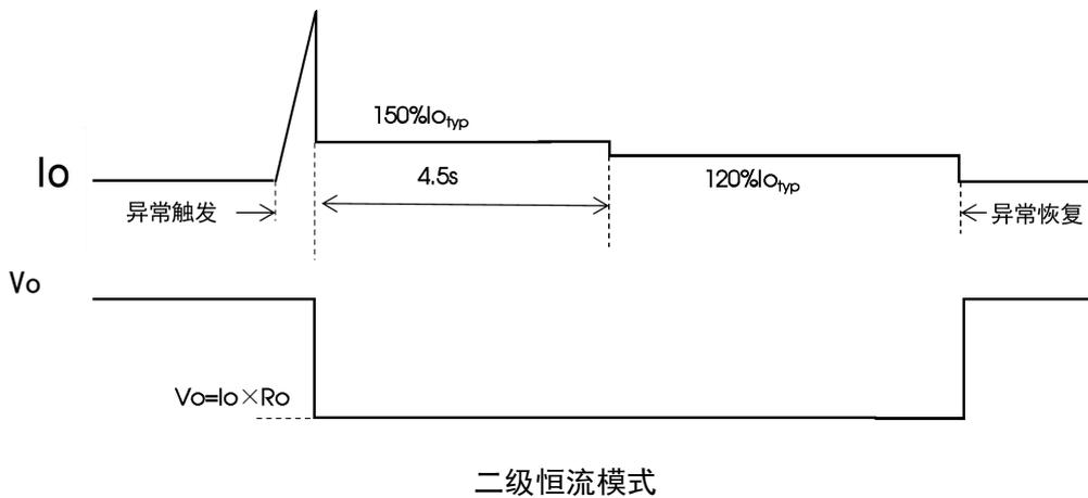
二级恒流模式：当输出电流超过 150% 额定输出电流时，输出会立刻进入恒流模式，电流大小会维持 4.5S 的 150% 额定输出电流，然后进入 120% 额定输出电流，同时输出电压跌落，过流异常结束后，自恢复。
