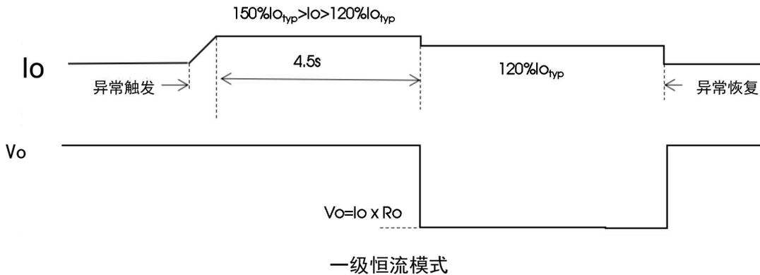
一级恒流模式：当输出电流超过 120% 额定输出电流且不超过 150% 额定输出电流时，输出会正常工作 4.5S 后进入恒流模式，恒流大小为 120% 额定输出电流，同时输出电压跌落，过流异常结束后，自恢复。
