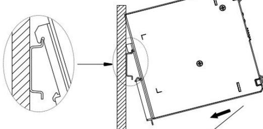
② 把产品本体垂直TS35导轨方向推, 直到听到卡扣卡入导轨的声音;
