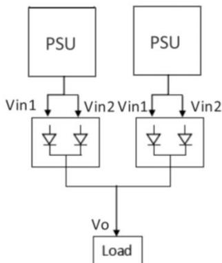
3. N+1 冗余：多台开关电源冗余，提高系统稳定性
