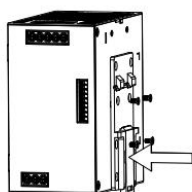
①安装通用DIN导轨适配器 (侧面正装，需撕标签纸)
