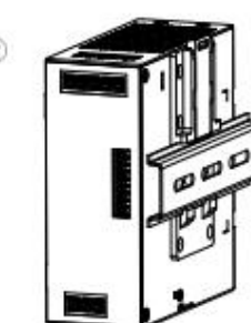
② 安装通用DIN导轨适配器 (侧面反装，需撕标签纸)
