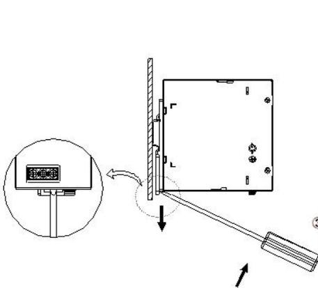
③用一字螺丝刀卡进卡扣底部方槽后, 按图示方向把卡扣滑块部分往下顶;
