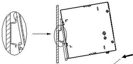
②把产品本体垂直TS35导轨方向推, 直到听到卡扣卡入导轨的声音;
