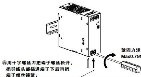
⑤用十字螺丝刀把端子螺丝松开, 把导线头部插进端子下后再把端子螺丝锁紧;
