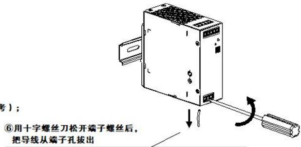
⑥用十字螺丝刀松开端子螺丝后, 把导线从端子孔拔出
