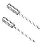
一字螺丝刀 刀头直径: 3mm
